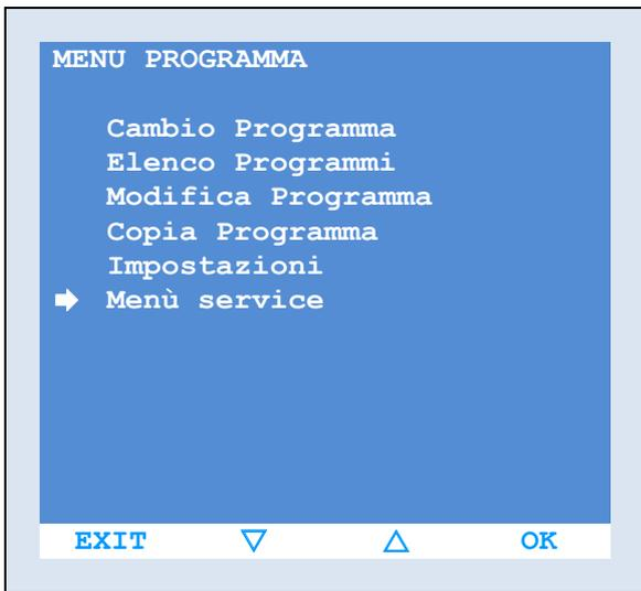
La voce "Menu Service" del "MENU PROGRAMMA" consente di settare i principali parametri di funzionamento della scheda.
