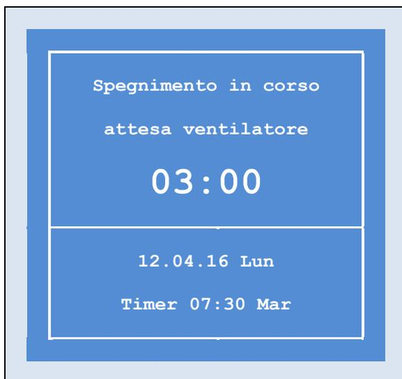
I 3 minuti di post-ventilazione sono fissati dal parametro " 408 " qualora si volesse cambiare questo tempo è sufficiente modificare il valore del suddetto parametro , vedi cap. impostazioni-parametri utenti
