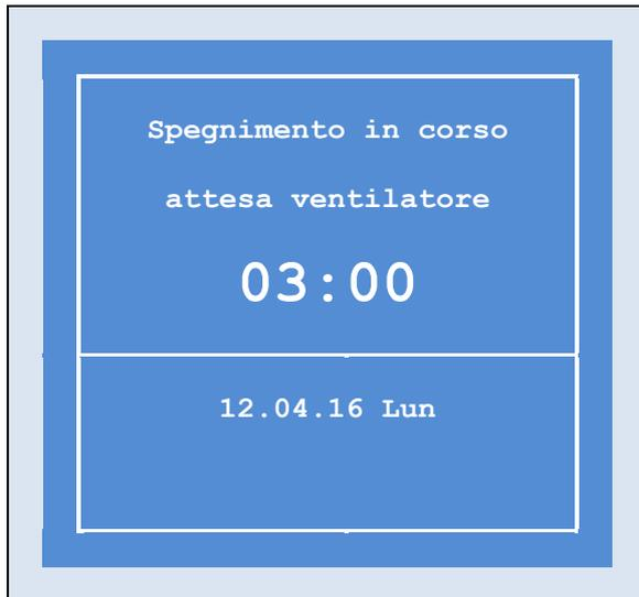
Alla pressione del tasto di spegnimento del forno il display visualizza il conteggio della post-ventilazione, al termine del quale il forno si spegne completamente.
