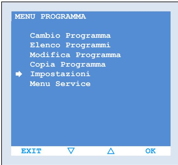
La voce “Impostazioni” del “MENU PROGRAMMA” consente di settare alcuni parametri di funzionamento della macchina.
